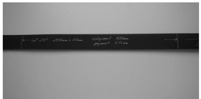
**Ter em atenção que é necessário verificar a tensão das correias após as primeiras 100 horas de operação e, se necessário, ajustar a tensão.**
