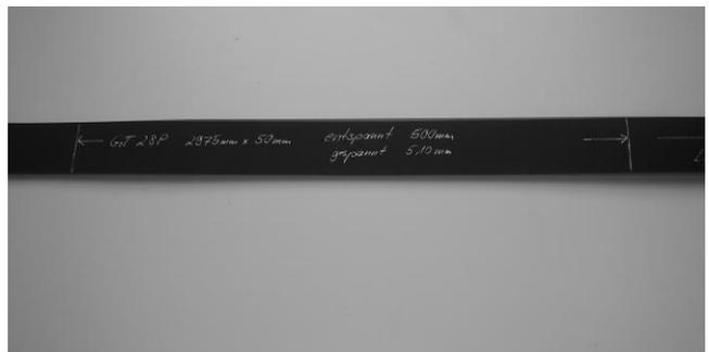
**Rețineți faptul că tensiunea curelei trebuie verificată după primele 100 ore de funcționare și cureaua trebuie tensionată dacă este cazul.**
