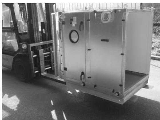
Na kamionu, delovi uređaja treba da se oprezno podignu montažnim gvožđem, kako bi viljuškar mogao da se uvuče.
