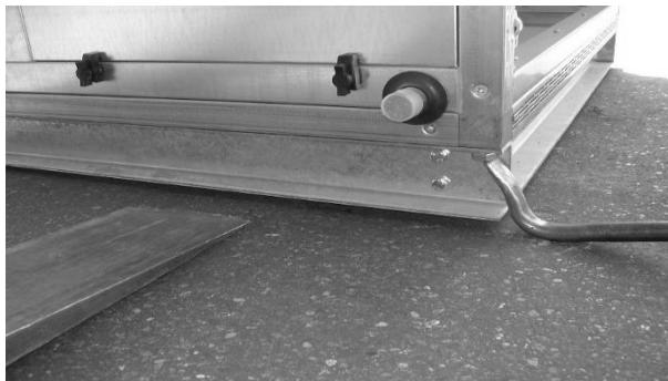
La charge maximale du chariot élévateur ne peut pas être dépassée pendant le transport des modules. Si la machine est équipée d'un châssis en tôle d'acier, alors la largeur du tablier porte-fourche du chariot élévateur doit être d'au moins 1 310 mm afin de pouvoir utiliser les ouvertures de transport prévues.
