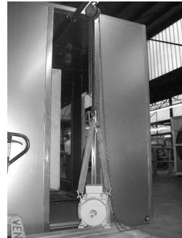
Le galet de roulement et le palan à chaîne ne doivent être montés que pour les travaux d'entretien et doivent être retirés une fois ceux-ci terminés. Ils ne doivent pas rester dans la machine lorsque la ventilation est en marche. Le contrôle de la glissière, du galet de roulement et du palan à chaîne doit être effectué régulièrement conformément à la norme DGUV V54 (treuils, appareils de levage et de traction).
